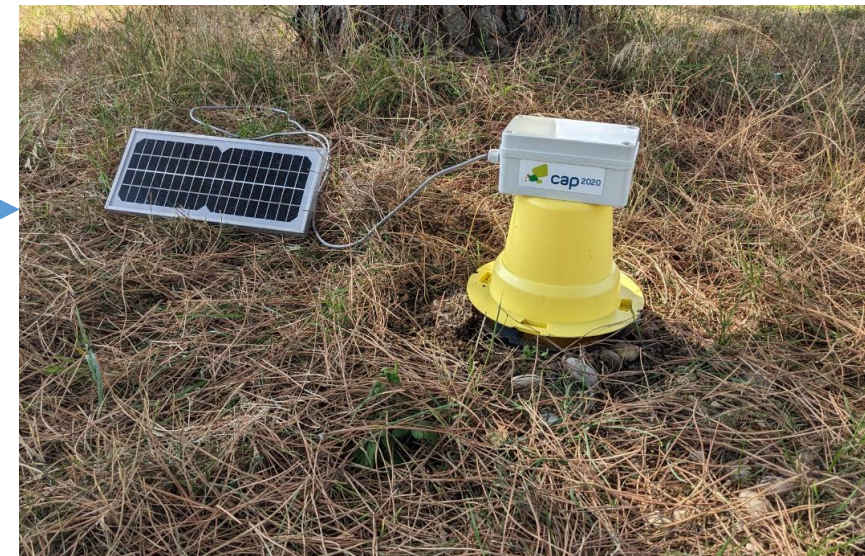
Piège CapTrap « pitfall » Installation au sol Permet de mailler un territoire (information spatiale et temporelle) Rôle de sentinelle
