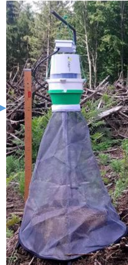
Piège CapTrap « émergence » Installation sur souche Détection l'émergence des hylobes (information temporelle)
