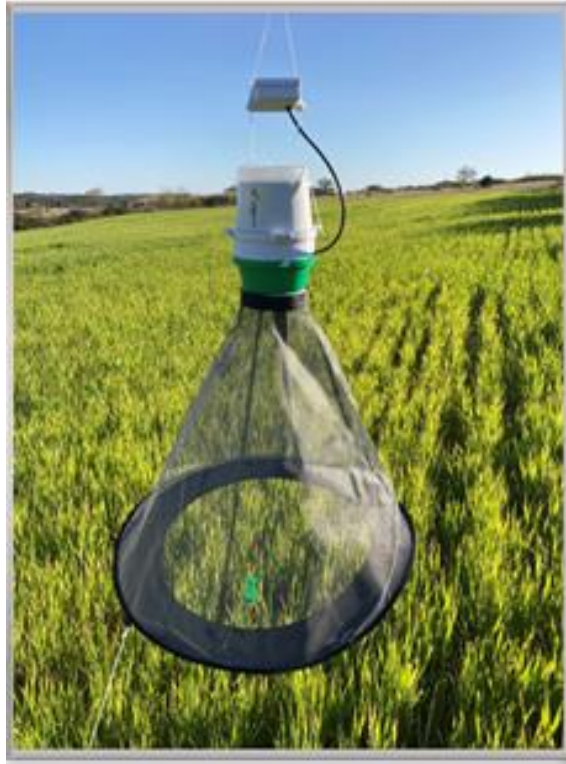
Piège CapTrap « nasse » Suivi pyrale et sésamie sur maïs
