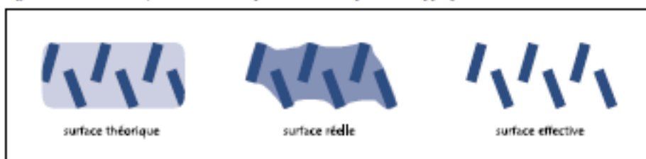
Figure 1 – Les trois surfaces considérées pour évaluer les pressions appliquées sur le sol.*
