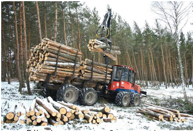
Débardage par porteur 8 roues motrices
