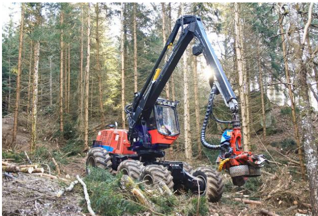
Combiné d'abattage-façonnage 6 roues motrices
